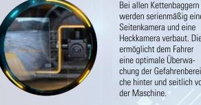
werden serienmäßig eine Seitenkamera und eine Heckkamera verbaut. Dies ermöglicht dem Fahrer eine optimale Überwachung der Gefahrenbereiche hinter und seitlich von der Maschine.
