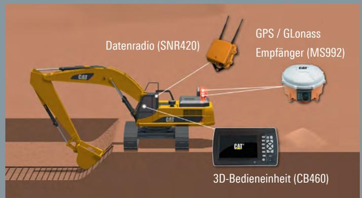
Die 3D-Steuerung nutzt die bereits vorhandenen beiden Winkelsensoren und das Längenmesssystem im Löffelzylinder (PSC) von CAT GRADE CONTROL.
