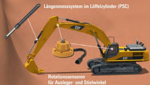
Längenmesssystem im Löffelzylinder (PSC)
