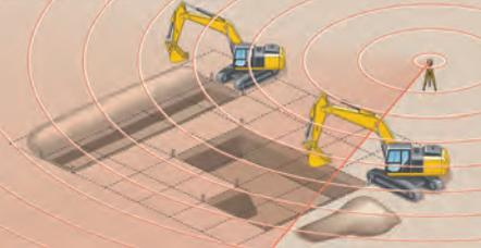
*Cat Grade Control (CGC) zeigt dem Fahrer in der Kabine die genaue Höhe und Neigung an der Löffelschneide an.*
