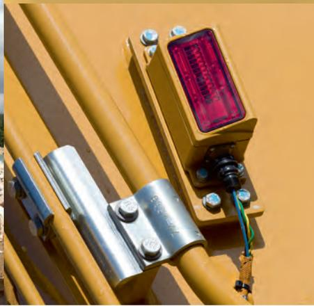
*Als Erweiterung des Arbeitsumfanges verfügt CGC über einen Laser Catcher (Laser-Empfänger), um eine Referenzhöhe von einem Rotationslaser zu empfangen. Dieses steigert den Aktionsradius des Baggers und gewährleistet eine gleichbleibende Höhengenaugigkeit über dem zu erstellenden Bauwerk.*
