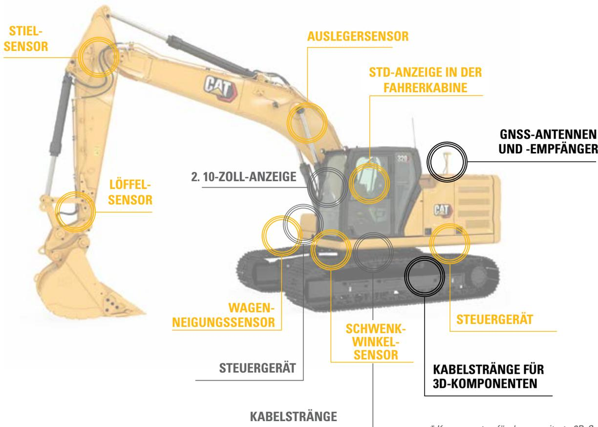
\* Komponenten für das erweiterte 2D-System werden auch für Grade mit 3D verwendet
