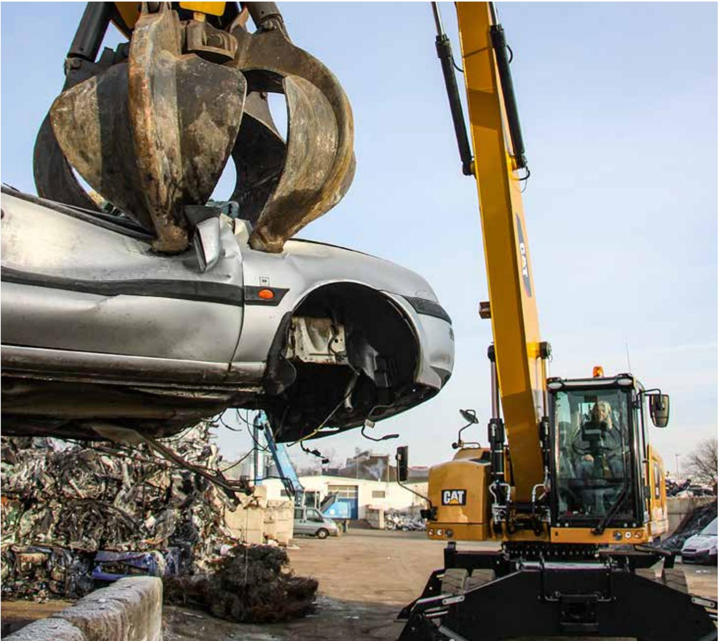
Alle Cat MH-Umschlagbagger mit Stufe-IV-Motor glänzen mit bis zu 10 % optimierten Kraftstoffverbrauch und haben den „Blauen Engel“ verliehen bekommen, weil sie extrem lärm- und emissionsarm sind. Alle Cat MH können auch mit Biodiesel B20 betrieben werden.
