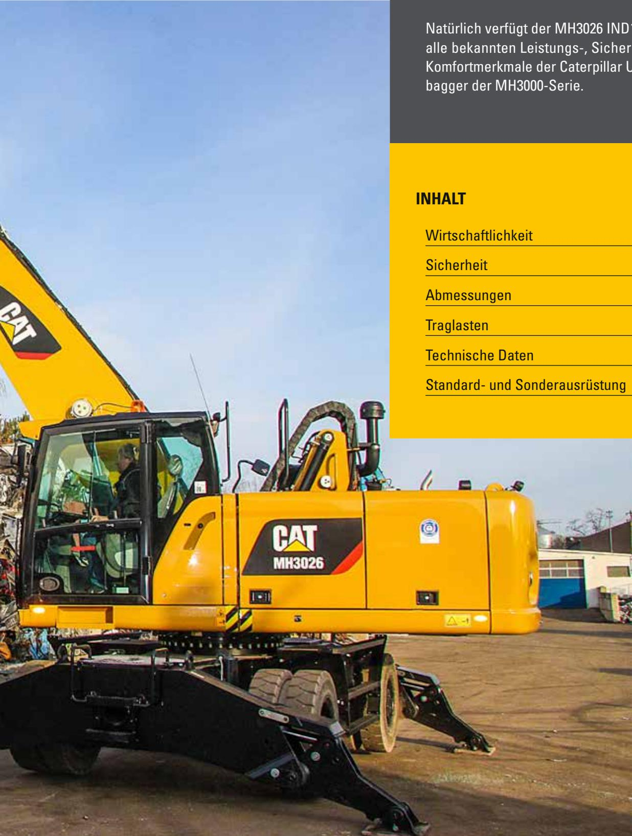
Für Einsätze, bei denen es vor allem auf hohen Materialumsatz gepaart mit großer Reichweite und schnellen Taktzeiten ankommt, ist der MH3026 IND134 die perfekte Lösung. Auch bei einer maximalen Reichweite von 13,4 Metern verfügt der MH3026 IND134 noch über ausreichend Traglasten und steht dabei durch seinen 2,99 Meter breiten Unterwagen immer sicher und stabil.
