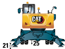
Laufwerk mit 2 Sätzen Abstützpratzen
